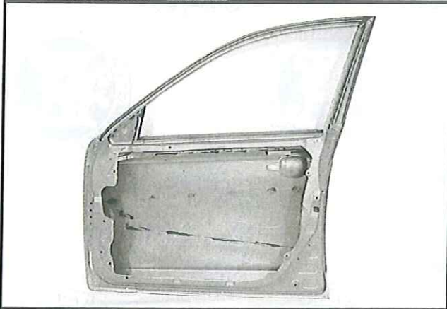
M7-1) Porte avant nue – face intérieure Bare front door – inner face
