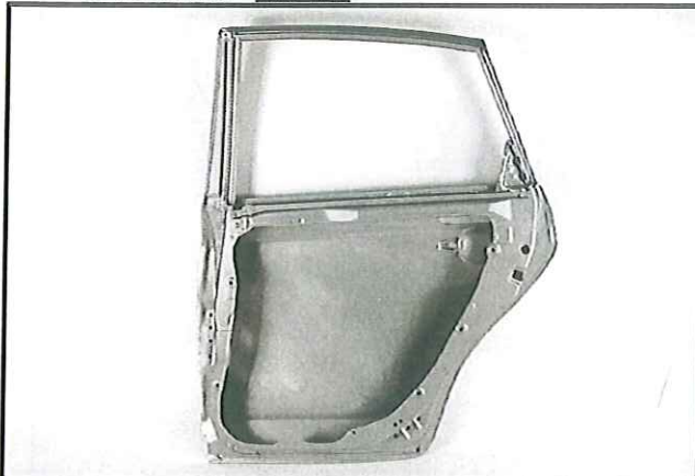
M8-1) Porte arrière nue – face intérieure Bare rear door – inner face
