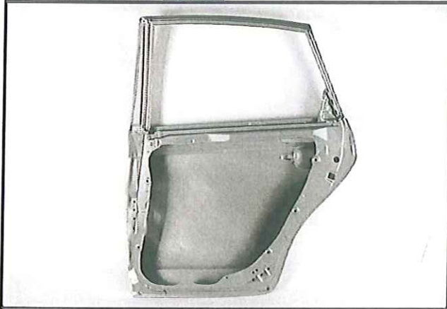
M8-1) Porte arrière nue – face intérieure Bare rear door – inner face
